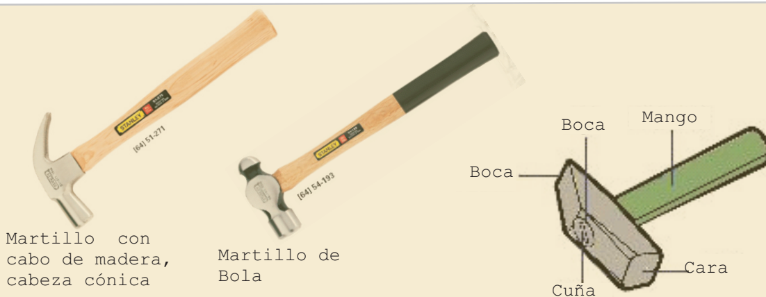
Figura 34. Ejemplos y Partes de un martillo
