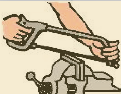
Figura 43. Pieza fijada firmemente antes de serrar
