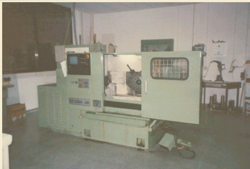
Figura 2. Fresadora de control numérico provista de resguardo móvil
